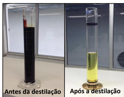
Figura 7.14. Produto \text{NbOPO}_4\text{-POORG1} , antes da destilação e o destilado de até 15% do produto \text{NbOPO}_4\text{-POORG1} .
